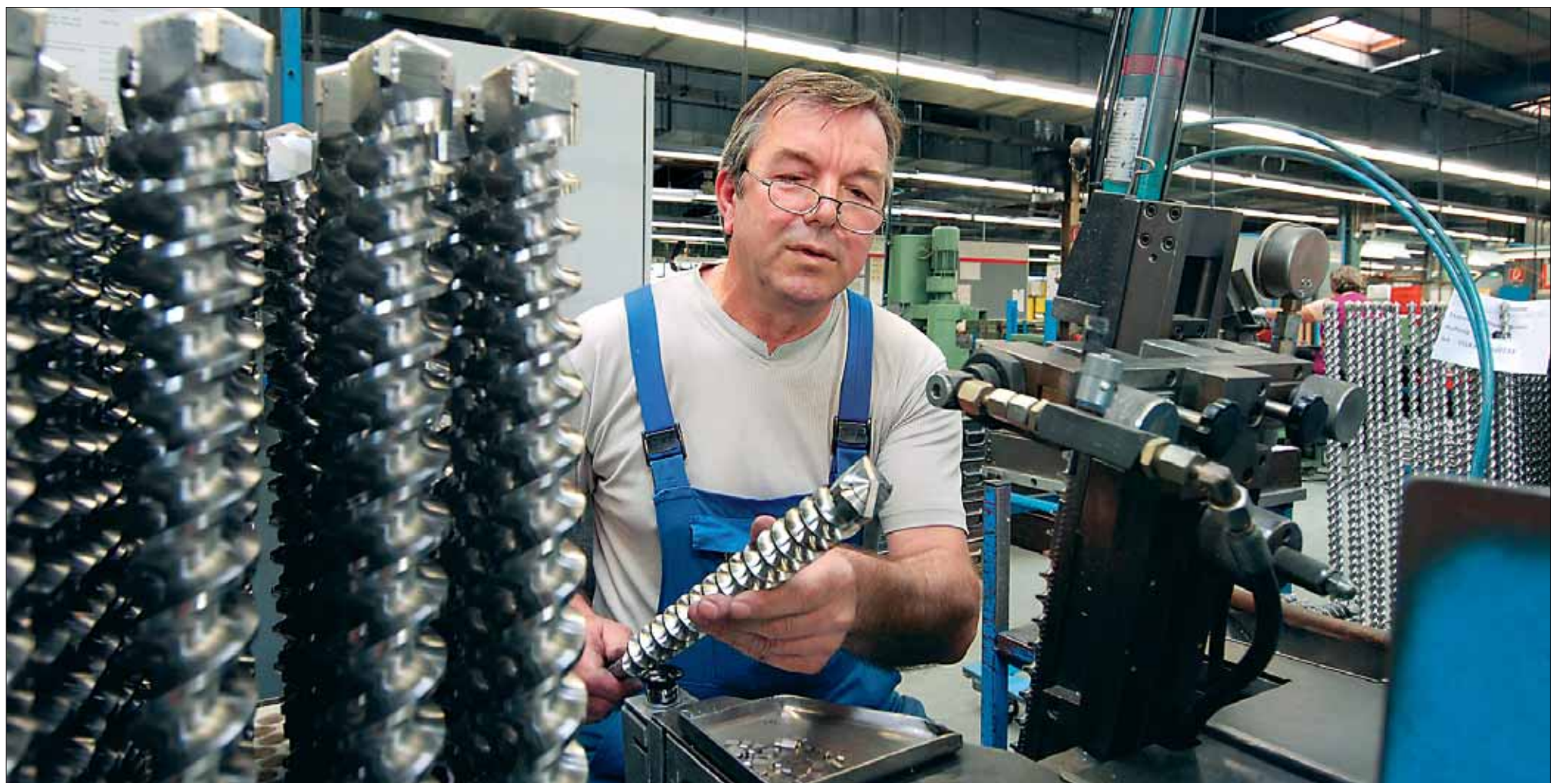
Kotoric Nedzad, ein aus Bosnien stammender Facharbeiter, legt in Großbohrer die Platten aus Hartmetall ein, die Hawera-Bohrer für Heimwerker und vor allem für Profi-Handwerker zum Qualitätswerkzeug machen. Fotos (5): Felix Kästle
